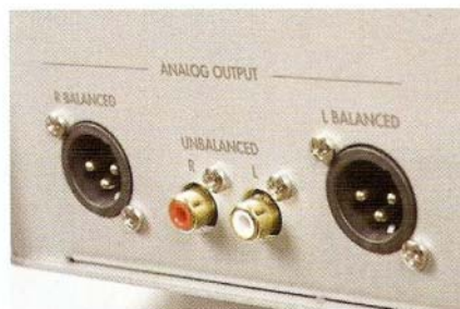
Układ odtwarzacza jest zbalansowany (już na etapie sekcji cyfrowej), zakończony parą wyjść XLR.
