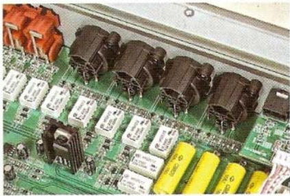
Przełączniki umieszczono tuż obok gniazdek wejściowych, co wydatnie skraca ścieżkę sygnału.
