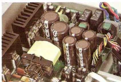
Wysokiej jakości, choć niekoniecznie potężne, zasilanie jest bardzo ważne we wzmacniaczu cyfrowym, wrażliwym na „brudy”.
