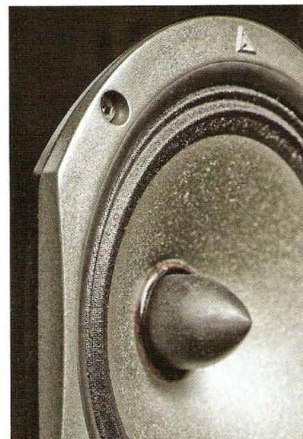
15 cm średnicy, delikatne tekstylne zawieszenie, lekka celulozowa membrana, nieruchomy korektor fazy – prawdziwy głośnik średniotonowy!
