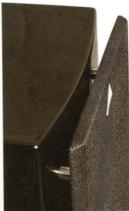
Plaska maskownica wyraźnie odstaje od łuku przedniej ścianki, dystansowana przez tuleje chwytające jej koleczki mocujące. Sama obudowa jest doskonale wykonana, a wszystkie krawędzie lekko zaokrąglone.
