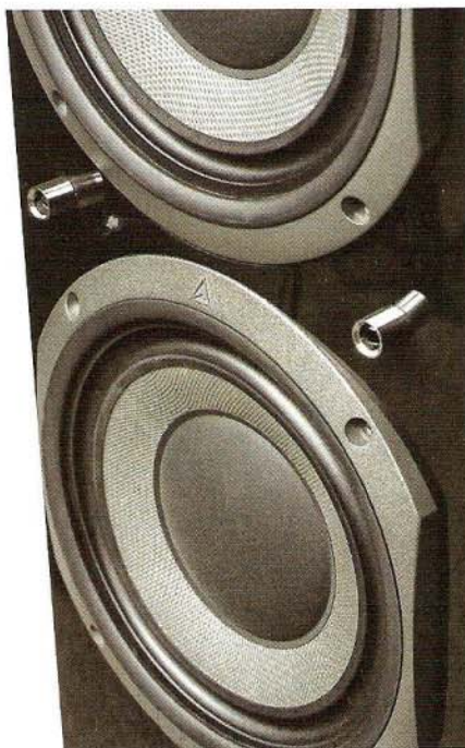
15 cm średnicy, delikatne tekstylne zawieszenie, lekka celulozowa membrana, nieruchomy korektor fazy – prawdziwy głośnik średniotonowy!
