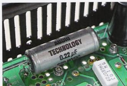
Kondensator na wejściu to wersja olejowa, produkowana specjalnie dla BAT-a.
