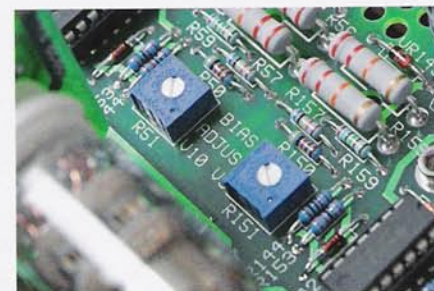
BAT wyposażył wzmacniacz w automatyczną regulację biasu lamp końcowych.
