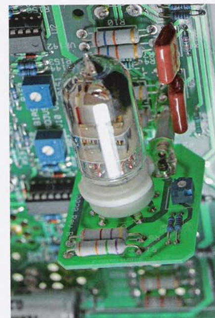
Lampa 6V6 wewnątrz obudowy to aktywne obciążenie katody lampy wejściowej.
