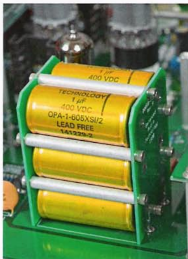
Sześć kondensatorów olejowych, czyli Six-Pak na wyjściu.
